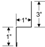
**NF-16 SIDEWALL FLASHING**
